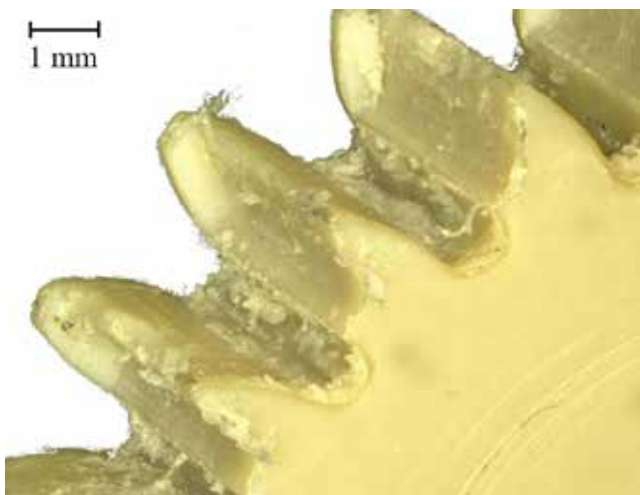
Slika 7 : Izrazita obraba zobnika iz PEEK-a, ki je bil testiran v paru z jeklenim zobnikom.
