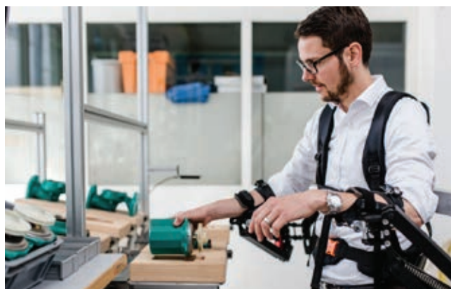
» Novi eksoskeleti poenostavljajo delovne operacije. | Vir: Fraunhofer IAO
