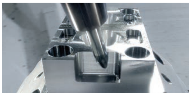
» Pri obdelavi je zelo pomemben tudi kot približevanja. V ta namen podjetje Hoffmann Group ponuja konična PPC-frezala ter konična PPC-frezala s konico s tremi različnimi koti približevanja. | Vir: Koller Formenbau
