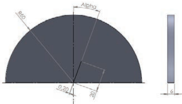
» Slika 4: Preizkušanec za preiskave parametrov lomne mehanike
