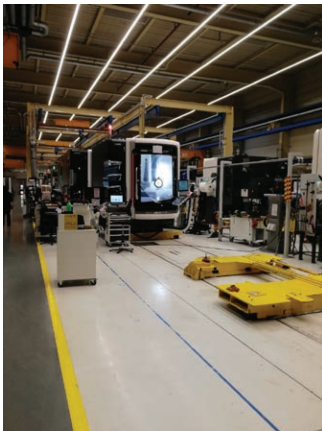
» Proizvodna linija obdelovalnih strojev. Na eni postaji obdelovalni stroj stoji v povprečju en delovni dan. Zadnja postaja je že prazna, ker je bil stroj dokončan in poslan naročniku.
