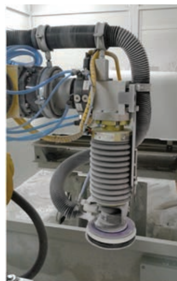
» Slika 3: Aktivni kontaktni vmesnik
