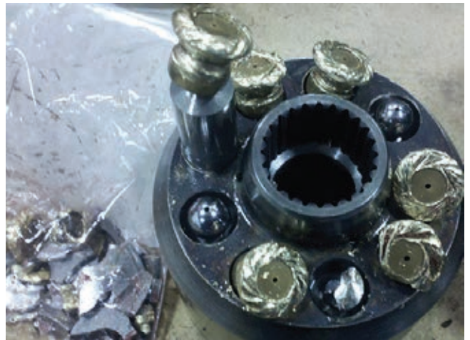
» Slika 3: Primer okvarjene aksialne batne črpalke [vir: Hydraulics&Pneumatics ]
