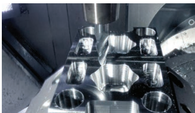
» Za obdelavo površin z zelo kompleksnimi geometrijami so na razpolago štirje različni profili sodčkastih prezal podjetja Hoffmann Group. | Vir: Koller Formenbau
