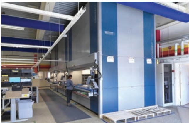
» Sistem za skladiščenje Compact Twin 3660 proizvajalca Weland Solutions. | Vir: Rimaster
