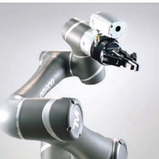
» Kolaborativni robot Omron serije TM s serijsko vgrajenim strojnim vidom in prijemalom
