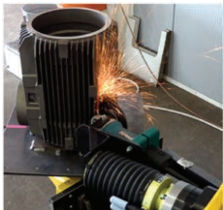
» Slika 7: Brušenje ohišja elektromotorja-peščen liv
