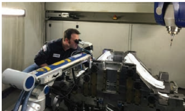
» Premična tehnologija za lasersko varjenje omogoča uporabnikom, da kjerkoli popravijo velika orodja, celo na 5-osnem obdelovalnem centru. | Vir: Phoenix Laser Solutions
