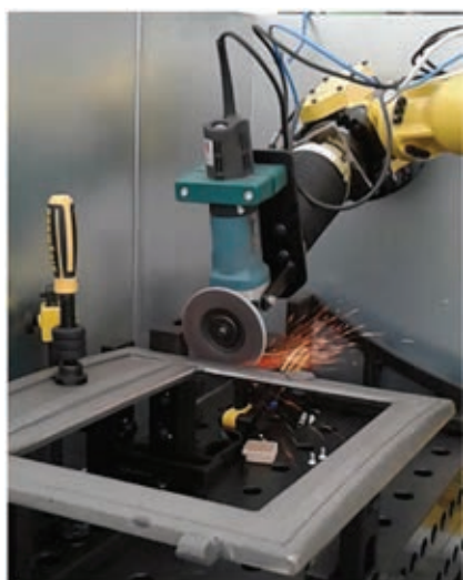
» Slika 8: Brušenje srha na odlitku
