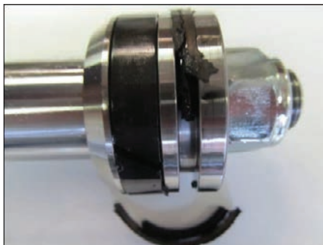
» Slika 2: Primer prekomerno poškodovanega batnega tesnila hidravličnega valja
