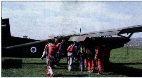
Vojaško letalo pilatus PC-6 uporablja predvsem na tih bojišjih. V njem je prostora za deset ljudi in je prilagojeno za pristajanje ter vzletanje na kratkih pistah in neobdelanih terenih.
