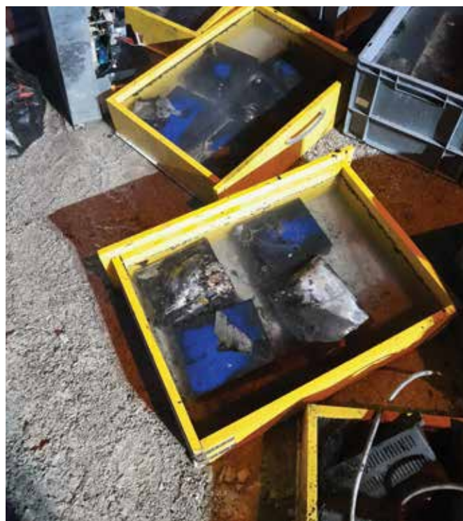
Slika 4: Zelo vroče litij-ionske baterije, potopljene v vodi v improviziranih posodah
