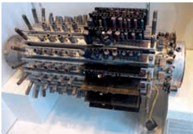
△ Namestitev komponent v računalniku UNIVAC I
