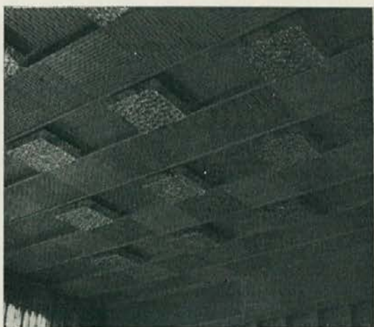
Naše stenske in stropne obloge so izdelane iz ivernih plošč in furnirane z različnimi plemenitimi furnirji (mahagoni, anigre, koto, jesen, brest, hrast, macesen, smreka). Površine so obdelane s polbleščečim lakom, v naravnih ali luženi izvedbi. Te obloge so bodisi gladke ali pa hrapave (otipljiva struktura lesa). Na stene in strop jih je lahko pritrditi.
