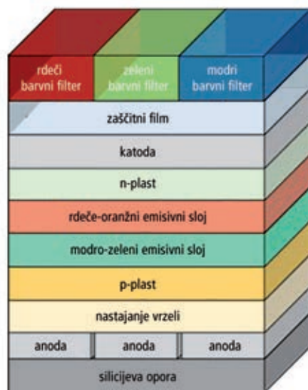
△ Pri tehnologiji LG W-OLED (levo) uporabljamo svetleče diode, oddajajoče belo svetlobo, ki jo obarvamo z barvnimi filtri. Pravi (telefonski) zasloni OLED (desno) uporabljajo različne svetleče diode za posamezno barvo. Slika: Amalkumar Ghosh
