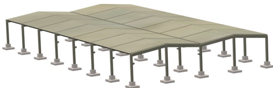
Slika 1.1: Enoetažna montažna industrijska hala Figure 1.1: Single-storey precast industrial building
