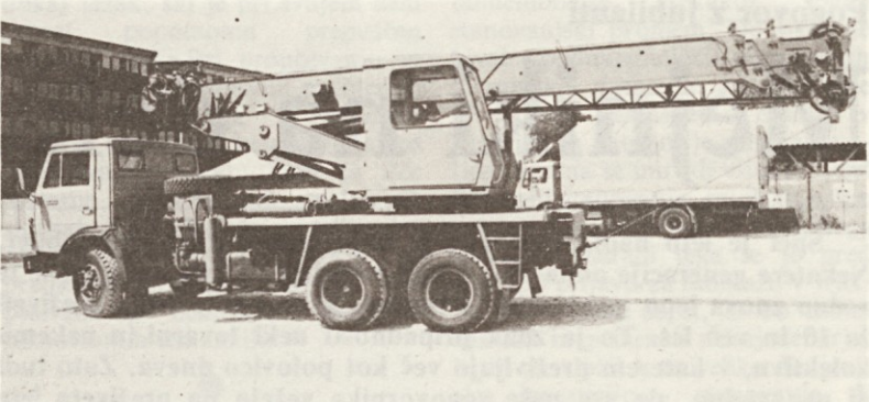
18-tonsko avtodvigalo (Foto: T. Š.)
