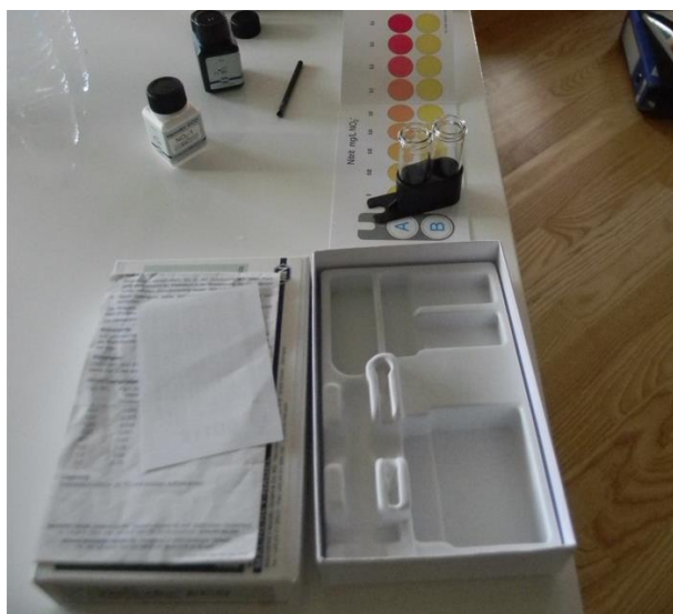
Slika 1. Prikaz dela laboratorijske analize – indikacija onesnažil s testnim kompletom. Avtor: Jana Breznik.
