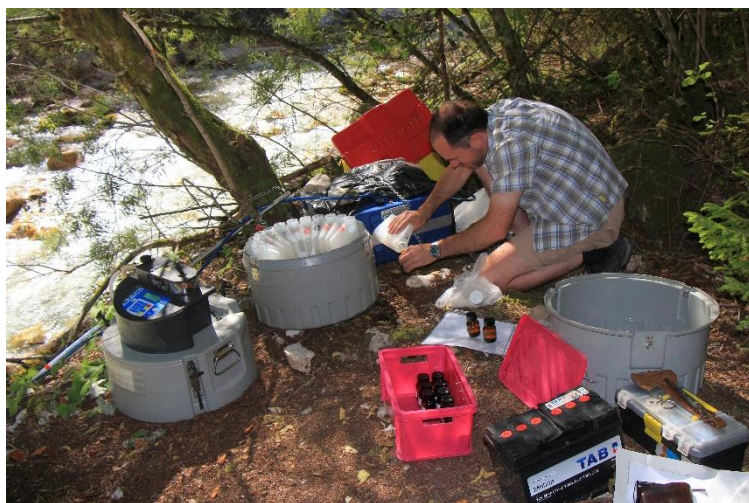
Slika 2. Pretakanje vzorcev vode na samodejnem vzorčevalniku na lokaciji Vrata/Peričnik. Avtor: Fotoarhiv ZRC SAZU, Geografski inštitut Antona Melika.
