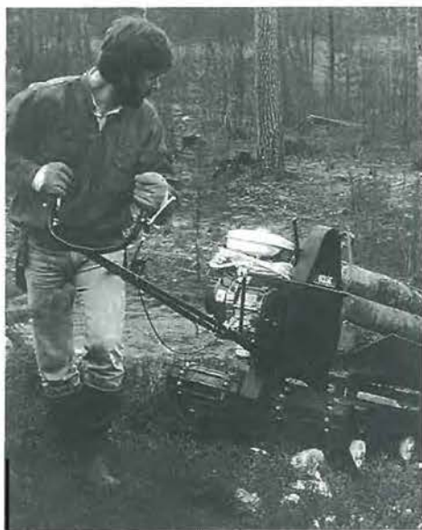
Ročni traktor z gumiastimi gosenicami je zlasti za spravilo lesa iz drogovnjakov hvaležen pripomoček
