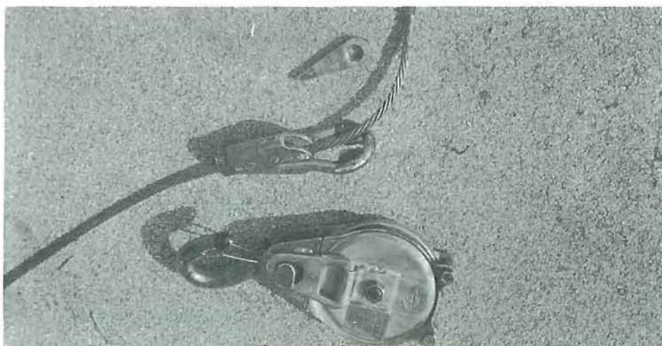
Škripec in zagozda za na konec vlačilne vrvi, proizvoda obrtnika Oblaka
