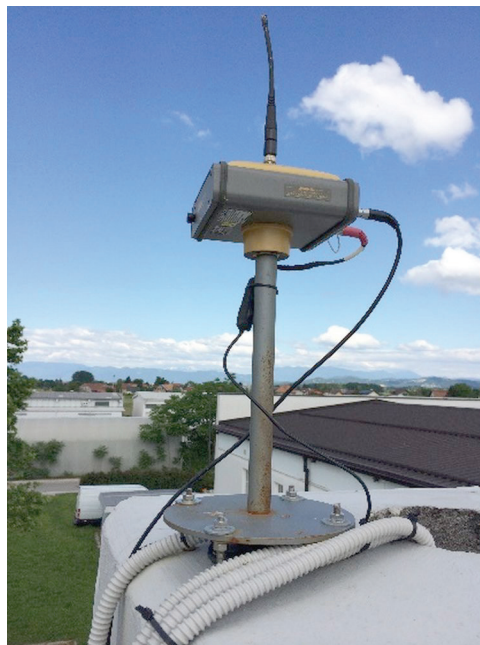
Slika 1: Stabilizacija referenčne točke z masivnim betonskim dimnikom in prikaz prisilnega centriranja antene GNSS na vijak z ustreznim navojem.
