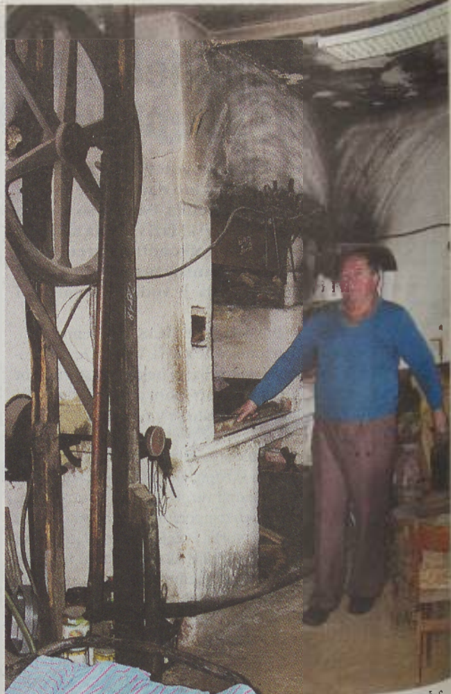
Rudolf Copot je pokazal, kako deluje ventilator na nožni pogon. – Foto: Š. S.
