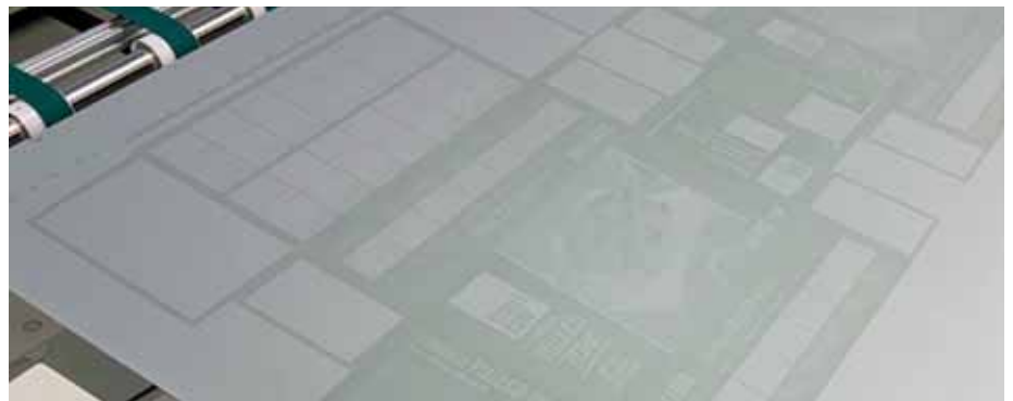
Brezkemijske CTP-plošče imajo slikovni kontrast, ki je očitno manjši v primerjavi s kemijsko razvitimi ploščami.
