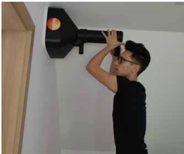
Slika 8 : Izvajanje meritev pretoka zraka z lijakom
