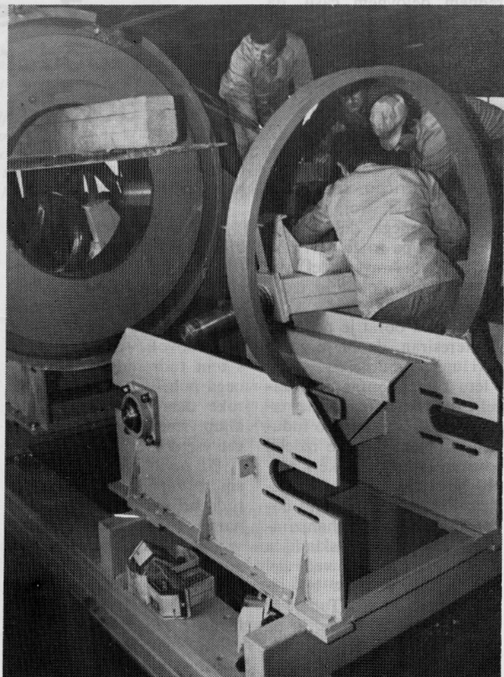
Montaža lupilnega stroja
