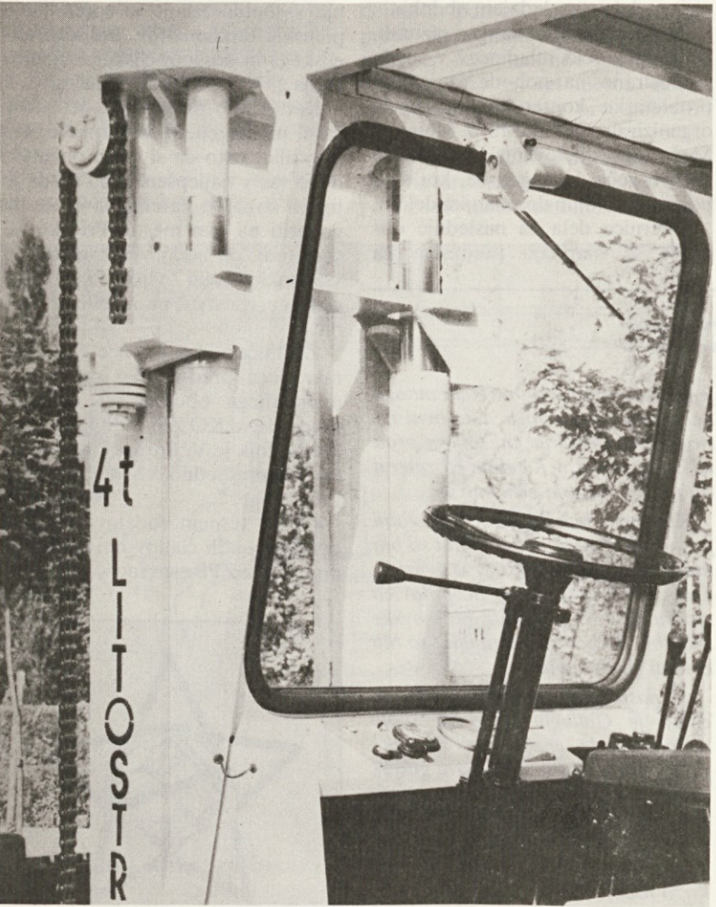
Detail preglednega dvigalnega mehanizma na 4-tonskem viličarju
