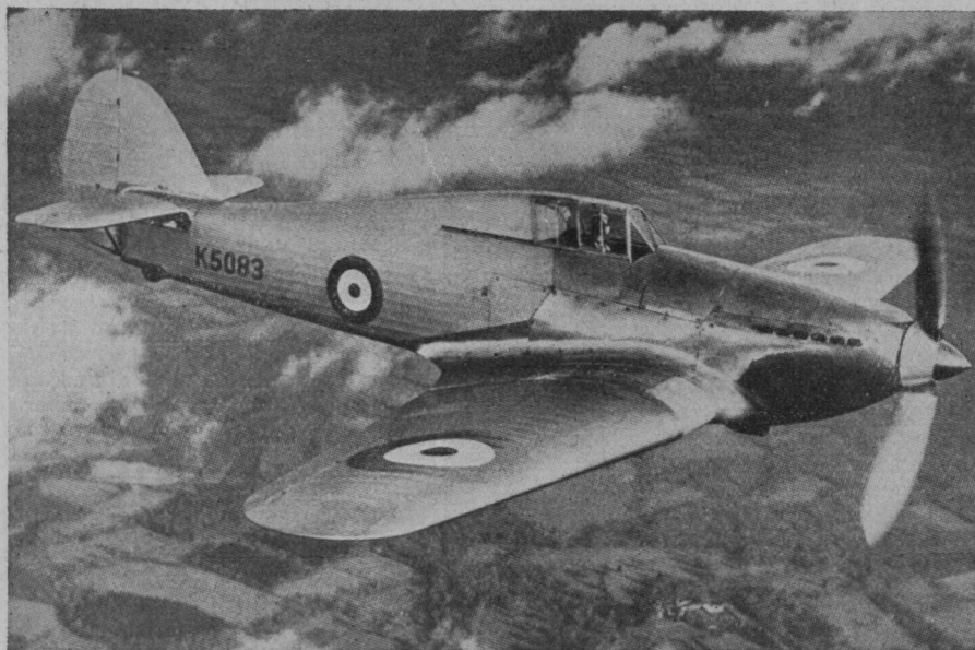
Angleški enomotorni bojni aeroplan »Henker« v poletu. Doseže hitrost 500 km na uro. Aeroplan ima poseben plašč iz lahkega finega jekla, ki zadržuje krogle iz pušk.
