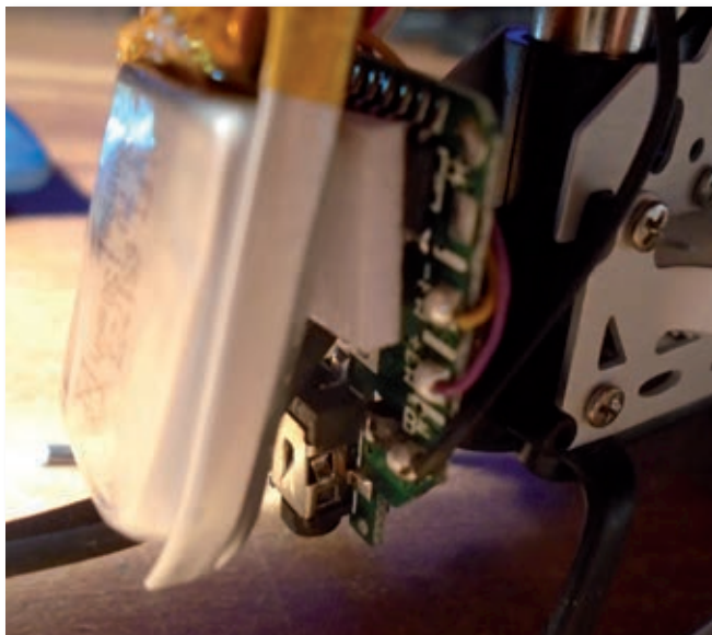
△ Litijeva polnilna baterija in krmilnik mini drona, pri katerem so vidni priključki in napajalni kabli krtačnih brezjadrnih elektromotorjev.
