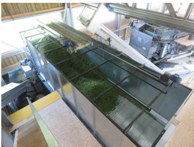
Nov zalogovnik zelenega hmelja s povezovalnimi trakovi (Foto: D. Vrhovnik)
