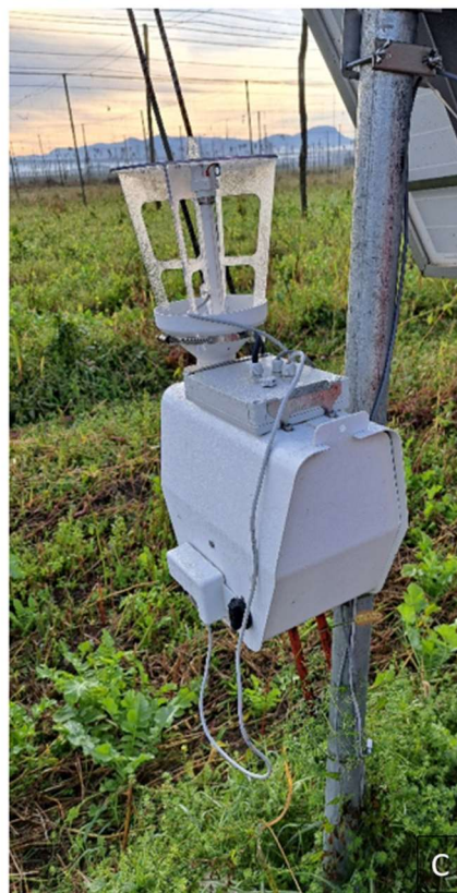
Različni tipi svetlobnih Trapview Aura pasti: A (15 W+4 W), B (15 W), C (9 W) za spremljanje leta metuljev koruzne vešče v letu 2024 (Foto: F. Poličnik).
