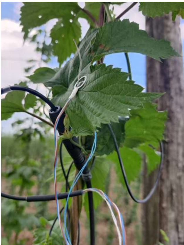
Slika 2: Senzor temperature lista in zraka (Foto: J. Ferlin)
