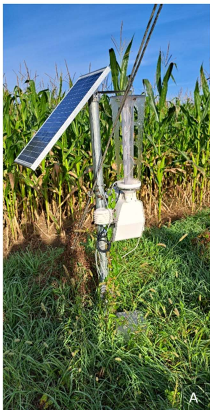
Različni tipi svetlobnih Trapview Aura pasti: A (15 W+4 W), B (15 W), C (9 W) za spremljanje leta metuljev koruzne vešče v letu 2024 (Foto: F. Poličnik).
