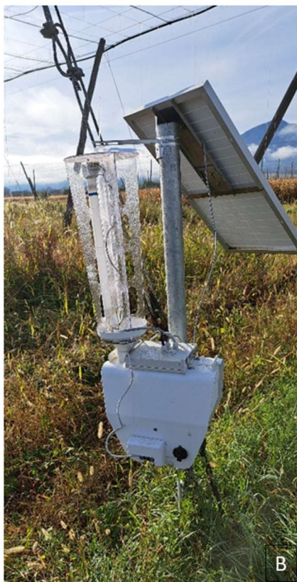
Različni tipi svetlobnih Trapview Aura pasti: A (15 W+4 W), B (15 W), C (9 W) za spremljanje leta metuljev koruzne vešče v letu 2024 (Foto: F. Poličnik).
