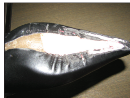
Slika 12. Nagubano usnje na podplatu, ki ga je potrebno odbrusiti. Konica čevlja je že obrušena.
