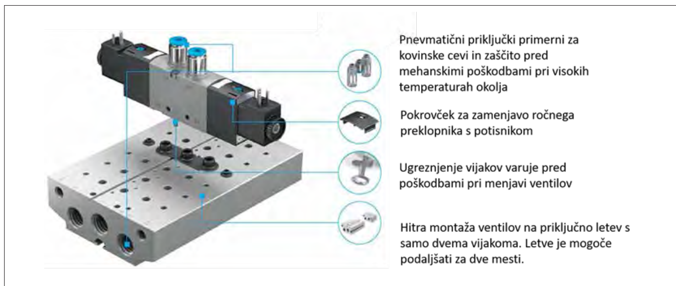
Slika 2: Številna dodatna oprema za hitro in enostavno pritrditev posamičnih ventilov
