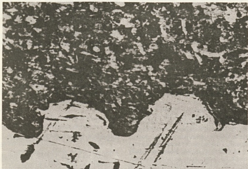
Sl. 2. Valovi, ki nastanejo na spoju jekla in bakra z eksplozivom (100-krat povečano).
