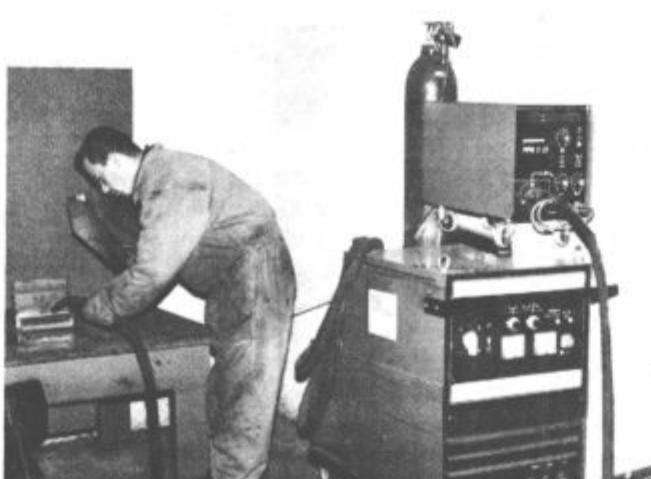
Stroj za varjenje s pulzirajočim oblokom
