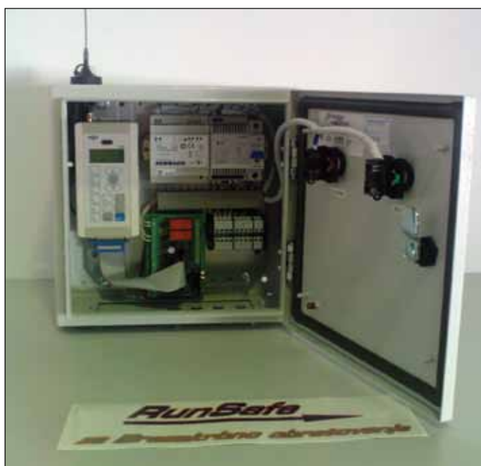
RunSafe aplikacija, na osnovi ultrazvočnega spremljanja kritičnih točk pri delovanju stroja, zagotavlja ukrepanje, preden pride do strojeloma in omogoča obveščanje o napakah preko SMS storitve
