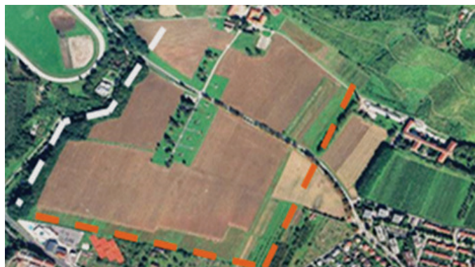
Slika 29 • Linija (bela) zgrajenih nalivalnih vodnjakov za bogatenje podtalnice na Vrbanškem platoju. Linija nalivalnih vodnjakov (rdeče) za zaščito pred vplivi mesta tudi po 30 letih ni zgrajena (Rismal, 2018).
