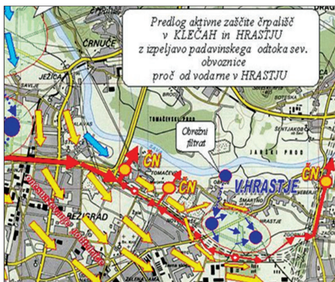
Slika 33 • Vodnogospodarsko in ekološko podprti načrt za bogatenje in istočasno zaščito pitne podtalnice vodarne v Hrastju s filtratom Save pred severno obvoznico in onesnaženo podtalnico izpod mesta (Rimal, 1999).
