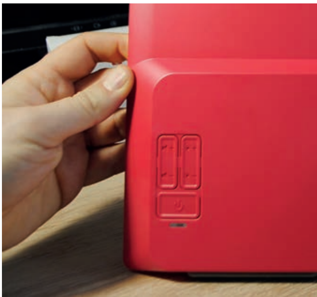
△ Na zadnji strani monitorja so gumbi za vklop ter nastavitve svetlosti in glasnosti.
