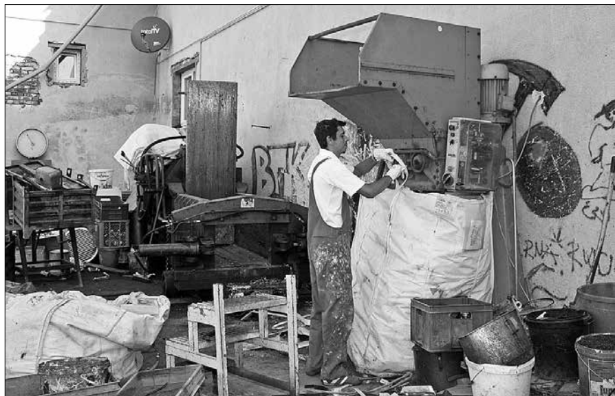
Poleg stiskalnice stoji močan drobilec, ki določeno vrsto kovine zdrobi na manjše kose.
