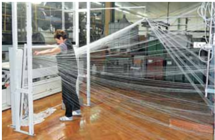
Niti na snovalu združijo in navijejo na osnovni valj.
