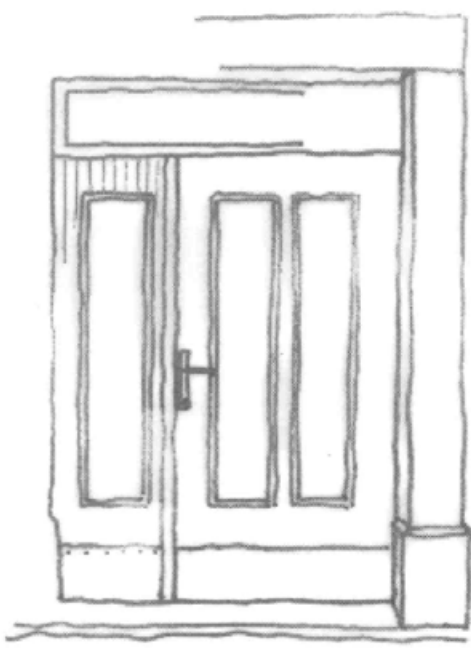
289. V petdesetih letih so v Verdu začeli zazidovati glavne občestne vhode. Redkeje so vhodno odprtino ohranili in jo zaprli z novimi vratnicami. Prelčeva vrata v Janezovi vasi so industrijski izdelek tovarne LIKO iz Verda.
