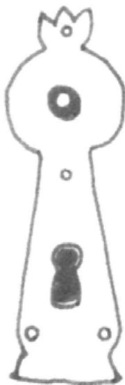
319. Podložka dvoriščnih vrat Žitkove hiše št. 13 iz leta 1836. Kljuka ni ohranjena. Ščitek je na vrhu zaključen s trolistno cvetno čašo, okrog odprtine za kljuko krožno rezan, navzdol se širi. Spodaj je dodatno razžirjen in ravno zaključen.
