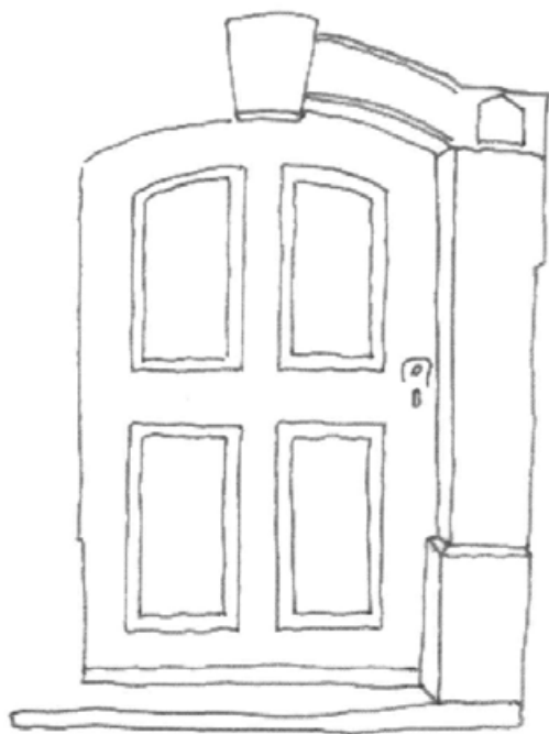
270. Vrata v "Unkovše" leta 1826 so enokrilna, sestavljena iz štirih enostavnih tabel, ki polnijo nosilni okvir.
