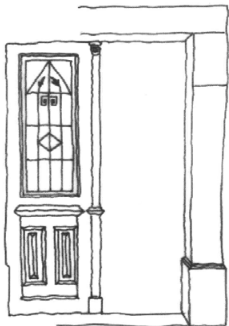
287. Ob prezidavi hiše so leta 1940 Furlanovi vzdali glavna vrata v dvoriščni vhod in preuredili tudi vratnice same – zgornje polje je mojster Rihar izrezal, ga zasteklil in zaščetil s kovano mrežo.
