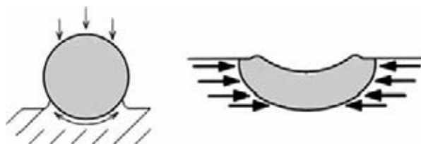
Slika 1: Zaradi udarne energije medija prihaja na površini do razrivanja materiala (levo), ki ustvari zaostale napetosti na površini in pod njo (desno) (1) .
