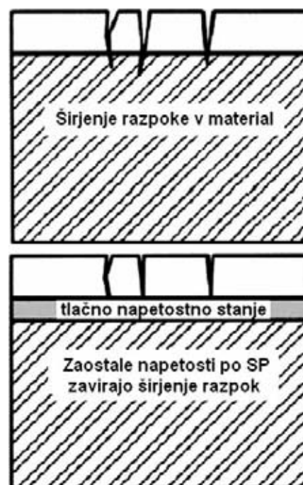
Slika 11: Preprečitev širjenja mikrorazpok z SP-obdelavo (1)
