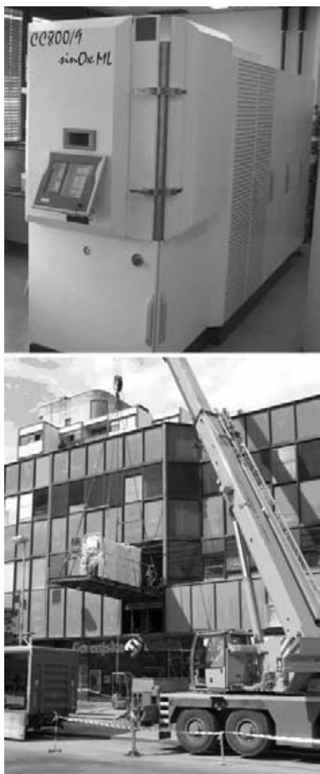
Slika 1: Nova naprava CC800/9 sinOx ML (zgoraj) in transport le-te v prvo nadstropje zgradbe v Domžalah, v kateri je Center za trde prevleke (spodaj)
