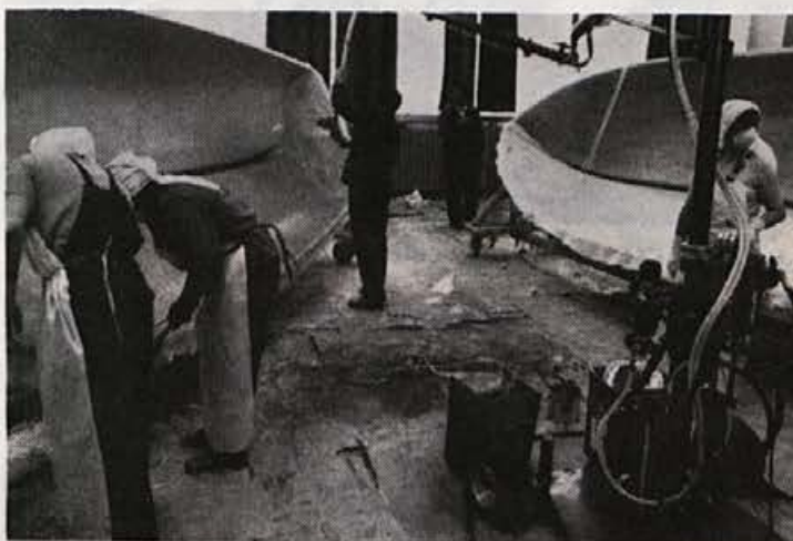
Experimentiranje z novimi stroji za nanašanje ojačanega poliestra za čolne
