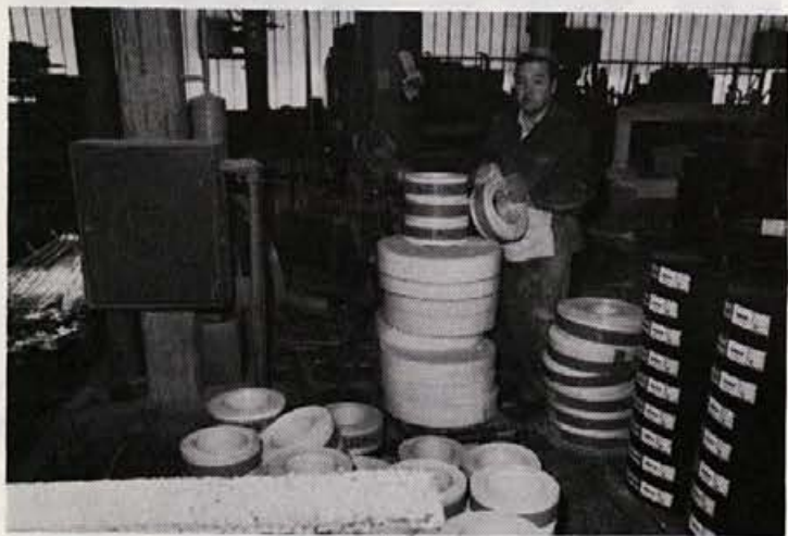
Material iz uvoza za proizvodnjo smučí se pripravlja na razrez za različne tipe in dolžine smučí
