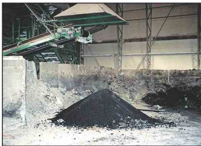
V solidifikat predelan gudron je sipek. Premogu ga dodajajo do 5 odstotkov.
