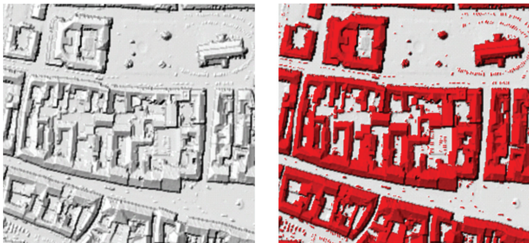
Slika 3: Prikaz površja z analitičnim senčenjem in samodejna zaznava objektov.
