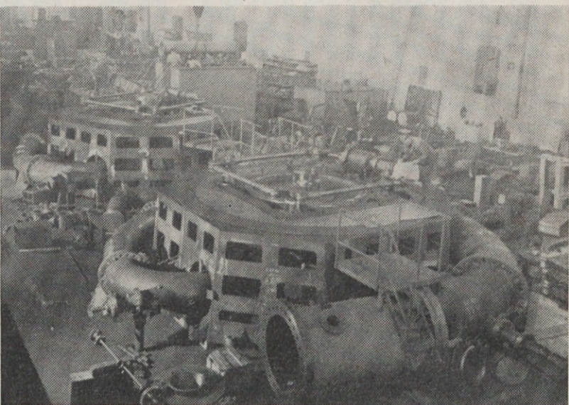
Na sliki sta agregata C in D v tovarniški montaži za HE Vrutok v mavrovskem sistemu. (P = 50.400 KM, om = 500 obr./min., padec = 520 m.) Prva dva agregata (A in B) sta pričela obratovati že pred petnajstimi leti
