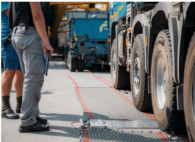
Na statičnih tehnikah za merjenje osnih obremenitev se meri osna obremenitev in skupna masa tovornega vozila, ki mora biti skladna z njegovo nosilnostjo. (foto: arhiv podjetja)
