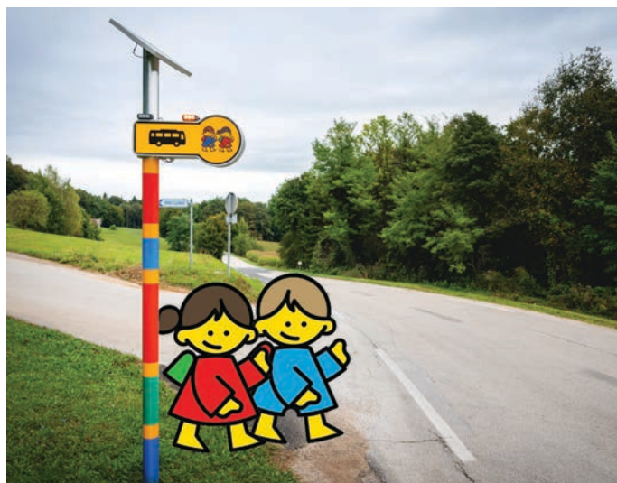
Sistem BUSko je sestavljen iz barvnega droga in opozorilne table, ki s svetlobnimi signali opozori voznike obeh smeri na prisotnost otrok v neposredni bližini. Sproži jo pametni oddajnik, ki je skrit v otrokovem obesku za ključe. (foto: arhiv podjetja)
