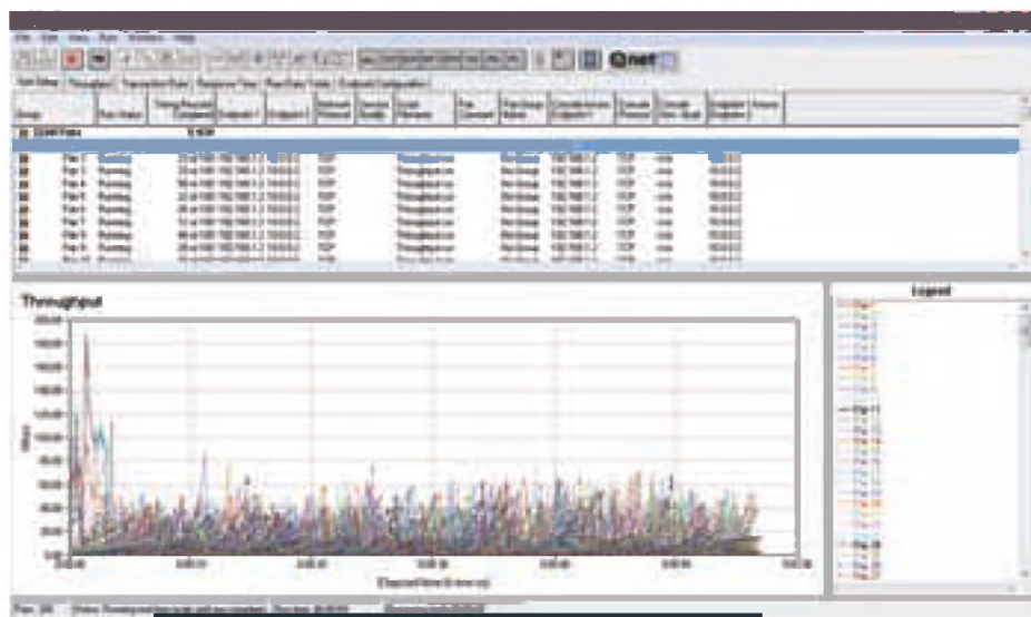
Na naši preizkusih vsak usmerjevalnik obremenimo do točke, ko podleže velikanski količini povezav.
