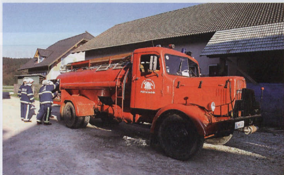
Gasilci iz PGD Smlednik so se pripeljali z 28 let starim gasilskim vozilom. V cisterni je prostora za 8000 litrov vode, zato z njim oskrbujejo tudi prebivalce s pitno vodo, kadar je suša ali kakšna druga naravna nesreča.
