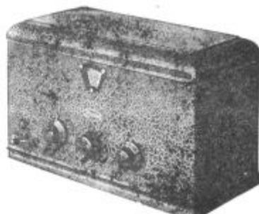
Troelektronski aparat »INGELEN« z visokofrekv. stopnjo za izmenični tok. Elektronke z zamreženo anodo. Vdelana lučna antena, ki se lahko prilagodi vsakemu električnemu omrežju
