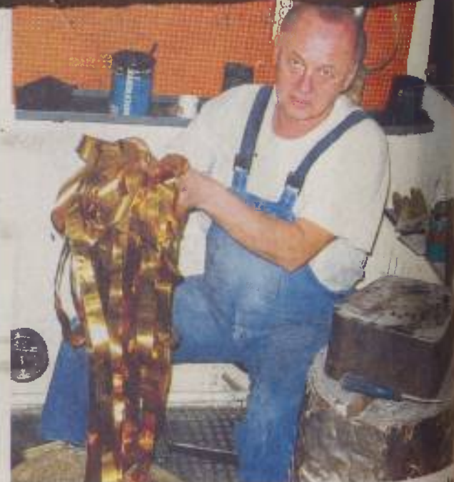
Tule sem na delovnem mestu, v rokah pa držim tanke trakove iz zlata, ki ga stanimo na »debelino« od 0,2 do 0,0009 milimetra. Poleg tanjšanja zlato v proizvodnem procesu tudi topimo, valjamo in režemo.
