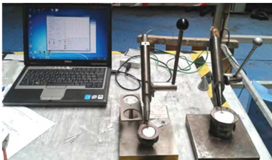
Sl. 7. Sistem za termično analizo in naprava za zbiranje podatkov NI
