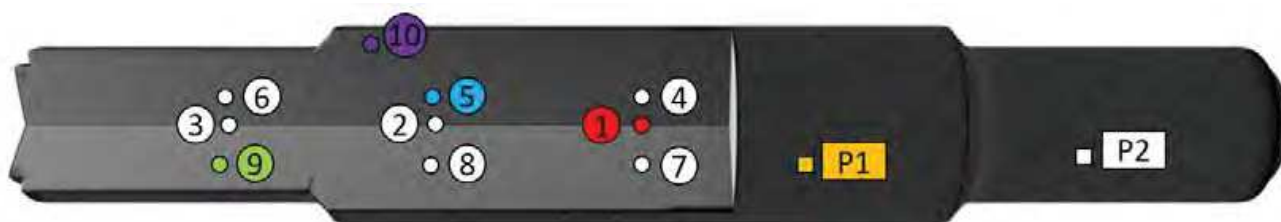
Sl. 2. Shematski prikaz delovnega valja, krogi: položaj termočlenov v valju, kvadrat: termočlen na površini
