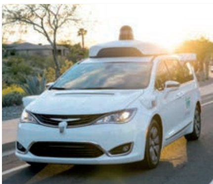
△ Prva generacija Googlovih samovozečih avtomobilov je imela okorne in drage (75.000 dolarjev) lidarje. Slika: Kathryn Myronuk, Forbes
