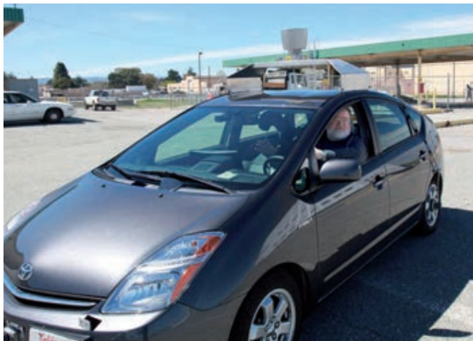
△ Prva generacija Googlovih samovozečih avtomobilov je imela okorne in drage (75.000 dolarjev) lidarje. Slika: Kathryn Myronuk, Forbes
