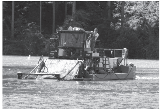
Slika 6: Plovilo s podvodno kosilnico, ki se uporablja za podvodno košnjo problematične vodne zarasti (pretežno vrste E. canadensis ) na Zbiljskem jezeru. (Vir: Delo)
