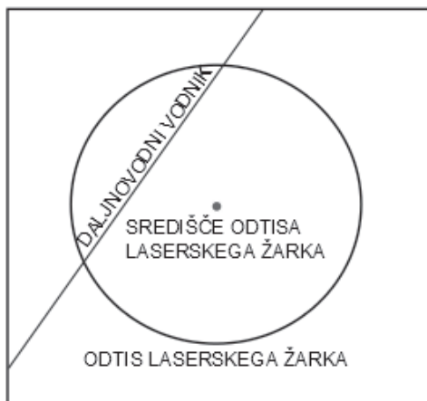
Slika 2: Položaj linijske tarče je geometrično določen s središčem odtisa žarka.
