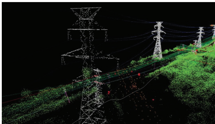
Slika 3: Prikaz oblaka točk na trasi daljnovoda.
