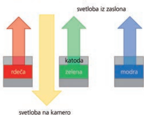
▽ Svetloba lahko do kamere pod zaslonom potuje skozi luknjice ali skozi transparentne diode. Slika: OTI
