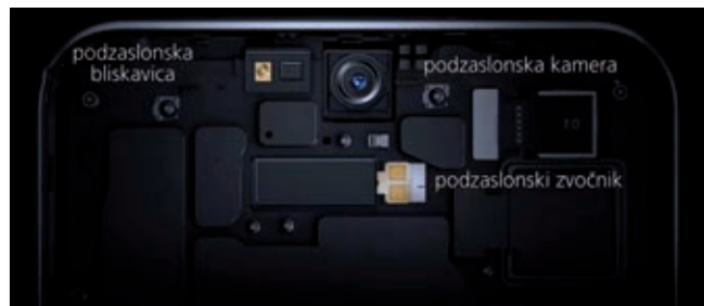
△ Kamera pod zaslonom na ZTE Axonu 5G. Slika: The Verge
