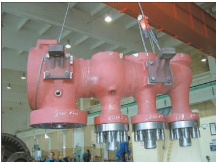
Dvigovanje ohišja turbinskih ventilov.
