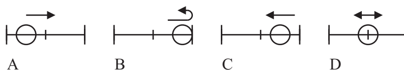
Slika 3.6: Iskanje domače pozicije aktuatorja. A – sklep se začne gibati v neznanem začetnem položaju. B – ko pride do konca območja gibanja, se ustavi (zaleti). C – takrat spremenimo smer gibanja. D – sklep pride do sredine območja gibanja, kjer ga ustavimo.
