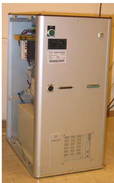
Slika 2.2: Skupno ohišje krmilnega računalnika in močnostnih ojačevalnikov
