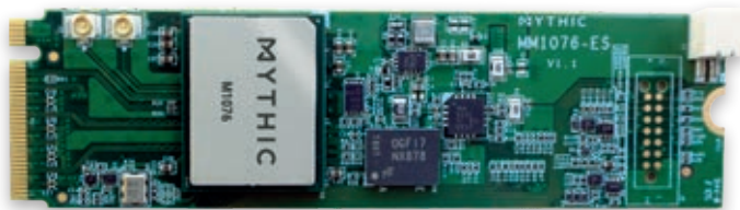
△ Analogni čip Mythic M1076 na digitalni razširitveni kartici.
