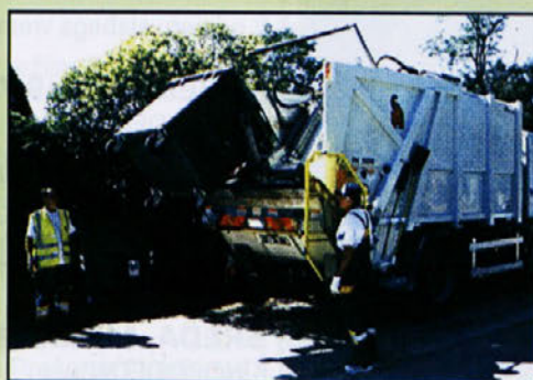
Nova pridobitev voznega parka izolske Komunalne: zaradi novejšega sistema za dvigovanje zabojnikov je praznjenje lažje in tišje.
