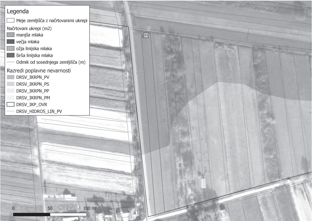
Slika 6: Primer prikaza oddaljenosti načrtovanega izkopa od sosednjih zemljišč z vrisom jarkov in vodotokov s podloženo karto razredov poplavne nevarnosti. (Avtorica: K. Drašler) Figure 6: Example of showing the distances of the planned excavation from adjacent land, showing ditches and watercourses, with an underlying flood hazard class map. (Author: K. Drašler)
