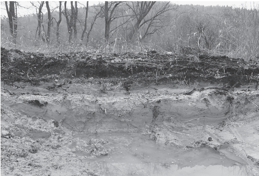
Slika 1: V talnem prerezu na Ljubljanskem barju je prisotna neprepustna plast, imenovana polžarica. (Foto: K. Drašler) Figure 1: The soil cross-section of the Ljubljana Marshes contains an impermeable layer called “polžarica”. (Photo: K. Drašler)
